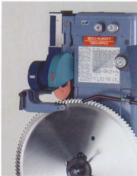
**Automatische Sägeblatt Schleifmaschine mit Klinkenvorschub,**
